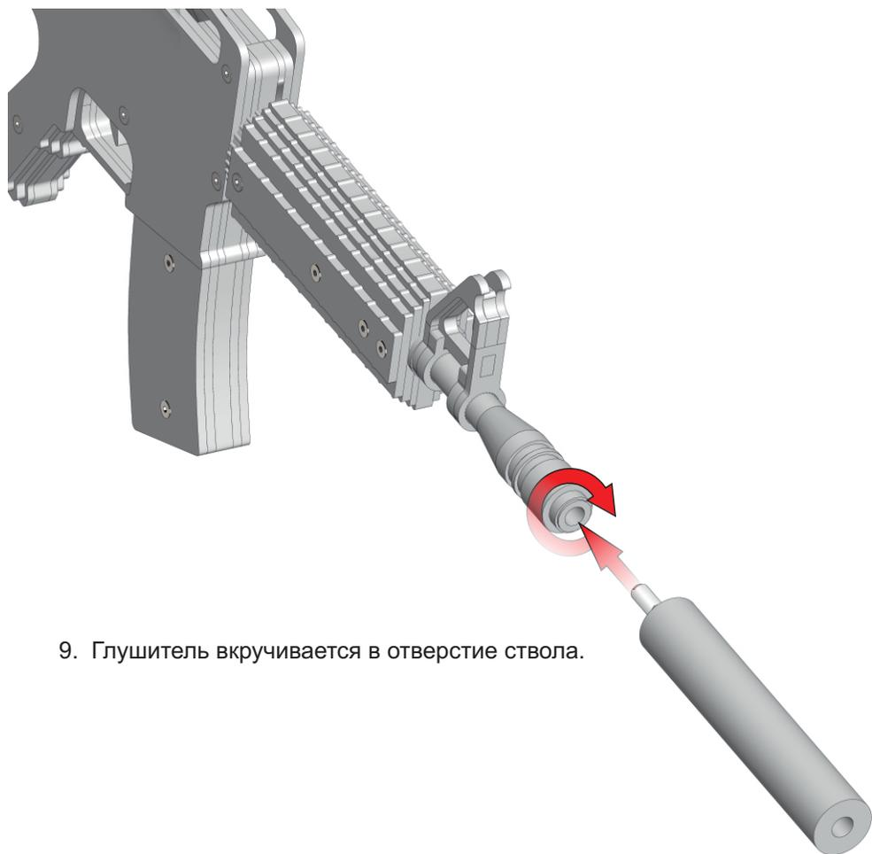
9. Глушитель вкручивается в отверстие ствола.
